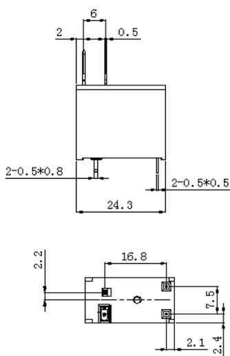
安装孔尺寸图 (底视图)
